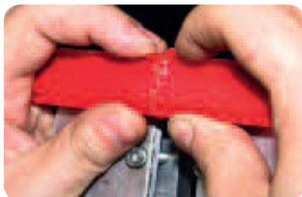
Schritt 4: Visuelle Überprüfung der Schweißnaht
