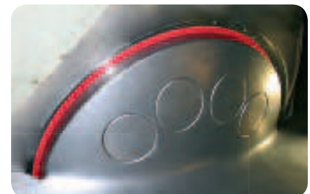
Schritt 6: Installierte Dichtungen für Laufschaufeln
