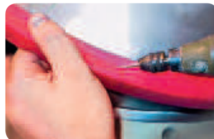
Schritt 5: Nachbearbeitung mit Spezial-Fräsmaschine
